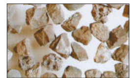
KA bzw. ..Z = Zirkonkorund sehr hohe mechanische Festigkeit
