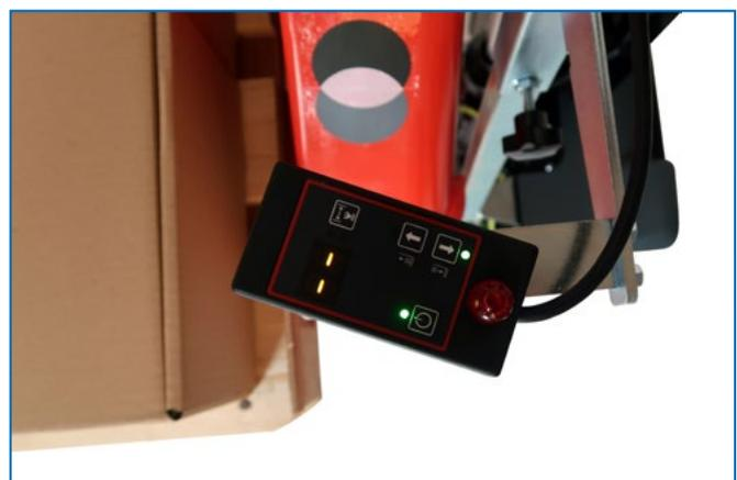
Die Bedienung der Positionskontrolle erfolgt intuitiv über ein Modul, in dem auch der Sensor integriert ist
