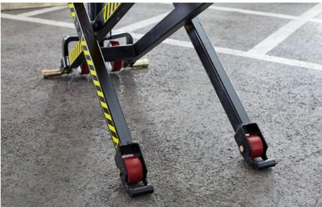
Lenkräder und Lastrollen mit besonders belastbarer Polyurethanbereifung
