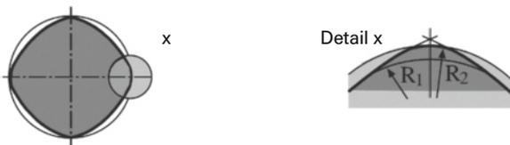
Die spanlose Innengewinde-Herstellung (Gewindeformen) im Vergleich zum Gewindeschneiden.
